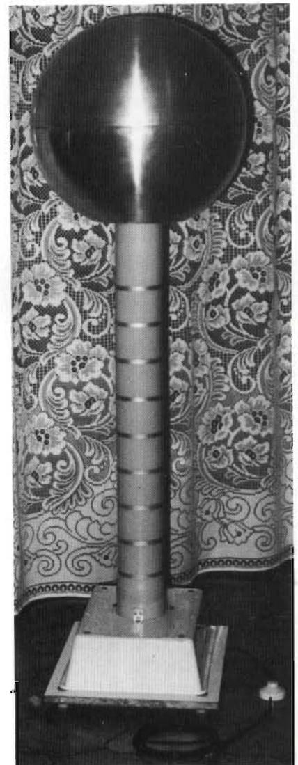
**Figura 2.** Così si presenta il Generatore di Van de Graaff completamente montato. L'interruttore azionabile col piede permette di avviare e spegnere la macchina senza doversi chinare nei pressi dell'elettrodo.
